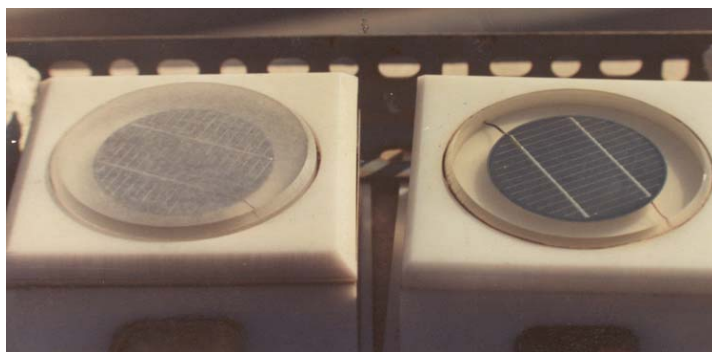
Σχήμα 8 Γεννήτριες για Μελέτη της Επίδρασης Σκόνης ή Λάσπης Πάνω στην Φωτοβολταϊκή Μετατροπή
